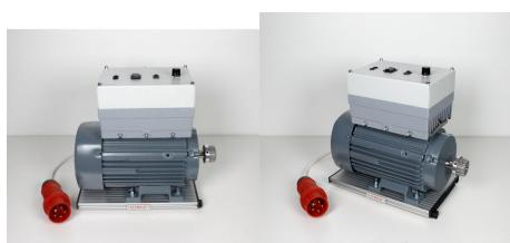
Machine asynchrone triphasée avec convertisseur de fréquence intégré pour le contrôle de la vitesse de 0 à 3900 min<sup>-1</sup> avec commutateur de sens de rotation pour rotation droite/gauche, bouton marche-arrêt et sortie de vitesse analogique (1 V / 1000 min<sup>-1</sup>).
