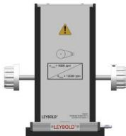
Entraînement par courroie pour basculer entre le moteur pour les tests de générateur 1,0 kW 7386311 et le générateur compact Kfz 7387111 pour augmenter la vitesse du générateur aux valeurs typiques pour les véhicules.
