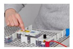
A1.1.3.4 Le capteur de roue magnétorésistif AMR Composants enfichables sur plaque STE
