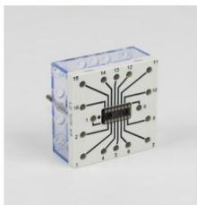
Élément enfichable avec support DIL à 16 broches pour circuits intégrés en boîtier DIL 16 broches.
