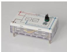
Capteur de pression du collecteur d'admission d'origine moderne avec interface SENT (Single Edge Nibble Transmission) selon SAE J2716 TM et une résistance pull-up intégrée pour une expérimentation facile.
