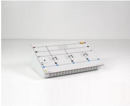
Charge capacitive triphasée, robuste et à usage universel, avec une puissance absorbée réglable jusqu'à 1 kvar. La capacité de chaque phase peut être modifiée individuellement en 15 pas, de 1,7  $\mu$ F à 26,3  $\mu$ F. Le pas et l'état de la charge sont affichés par des bandes lumineuses à LED de couleur sur la face avant.
