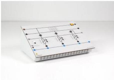
Charge ohmique triphasée, robuste et à usage universel, avec une puissance absorbée réglable jusqu'à 0,3 kW. La résistance de chaque phase peut être modifiée individuellement en 15 pas, de 7020 à 470. Le pas et l'état de la charge sont affichés par des bandes lumineuses à LED de couleur sur la face avant. La charge convient parfaitement pour la transmission des notions de base en électronique de puissance et en génie électrique aux apprentis et étudiants.
