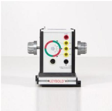
Pour détecter la position du rotor d'un moteur à courant continu sans balais et à aimants permanents (machine synchrone auto-pilotée).
