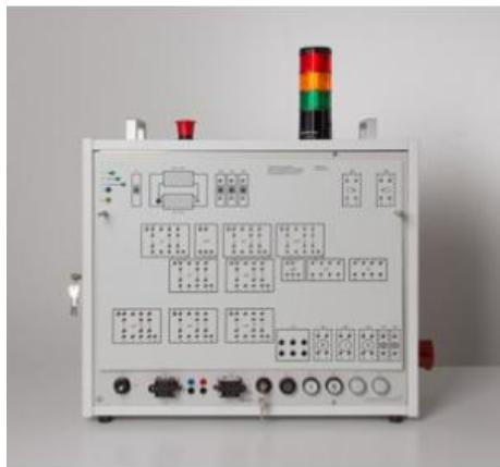
Dépannage dans les circuits à contacteurs. Appareil compact avec simulation de défaut intégrée.
