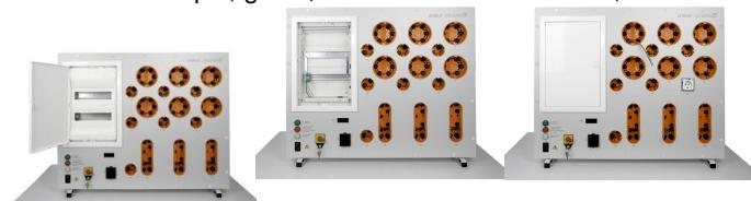
Mur de montage pour la réalisation d'exercices pratiques dans le domaine de la technique d'installation. Équipé d'une distribution secondaire et de divers boîtiers d'installation encastrés (boîtiers de dérivation et boîtiers d'interrupteurs) reliés entre eux par des tubes.
