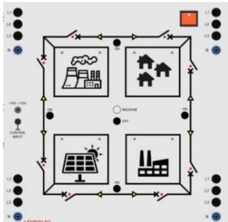
Le maillage réseau est la solution idéale pour mettre en réseau jusqu'à quatre générateurs ou consommateurs d'électricité séparés géographiquement dans le Smart Grid.
