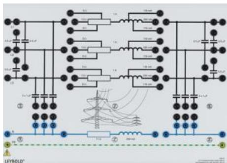
Simulation d'une ligne de transport triphasée 380 kV pour une mesure d'états de service stationnaires (marche à vide, adaptation, court-circuit).
