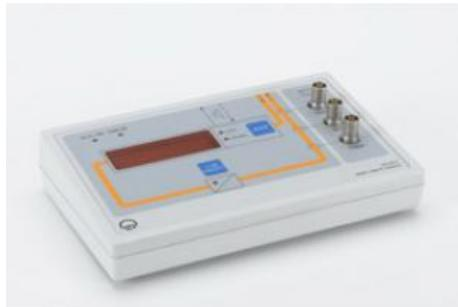
Interface pilotée par menus pour la connexion à un réseau MOST25 pour l'enregistrement (journalisation) et l'analyse des données.
