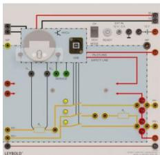
Cet appareil, en plus du modèle HV Battery "Cells", 739 952, est utilisé pour apprendre à activer une batterie haute tension dans une expérience.
