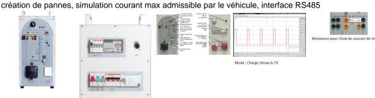
Le dispositif « borne de recharge pour véhicule électrique » est un outil pédagogique pour la formation sur la technologie haute tension des véhicules électriques.
