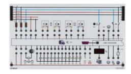
Quatre capteurs (Hall ou inductifs) de vitesse de rotation de roue, un capteur d'angle de rotation et d'accélération transversale ainsi gu'une pédale de frein peuvent être raccordés côté capteurs.
