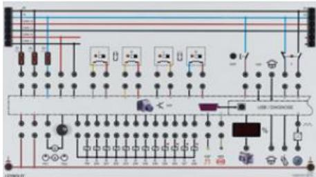
Quatre capteurs (Hall ou inductifs) de vitesse de rotation de roue, un capteur d'angle de rotation et d'accélération transversale ainsi qu'une pédale de frein peuvent être raccordés côté capteurs.
