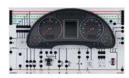
Combiné d'instruments avec compte-tours, tachymètre, affichage de la température et de la réserve de carburant, à affichage graphique haute résolution d'informations pour le conducteur.
