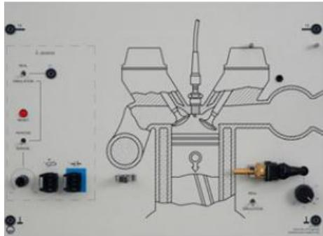
Avec représentation schématique du système d'aspiration et d'évacuation des gaz d'échappement, simulation et utilisation réelle de la sonde Lambda et de la sonde de température du moteur, masques KE-Jetronic et LU-Jetronic/Motronic inclus.
