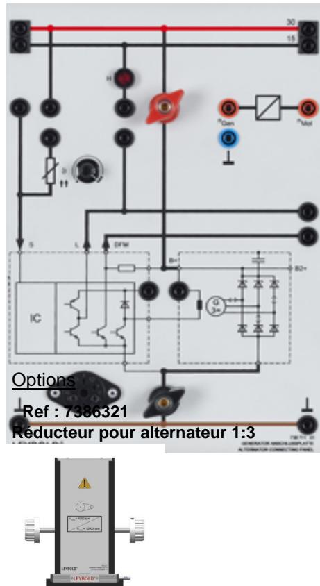
Entraînement par courroie pour basculer entre le moteur pour les tests de générateur 1,0 kW 7386311 et le générateur compact Kfz 7387111 pour augmenter la vitesse du générateur aux valeurs typiques pour les véhicules.
