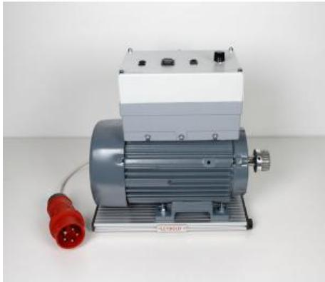
Machine asynchrone triphasée avec convertisseur de fréquence intégré pour le contrôle de la vitesse de 0 à 3900 min<sup>-1</sup> avec commutateur de sens de rotation pour rotation droite/gauche, bouton marche-arrêt et sortie de vitesse analogique (1 V / 1000 min<sup>-1</sup>).
