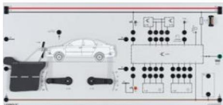
Le système complet « Correction automatique et dynamique de la portée d'éclairage » montre la compensation des changements de la portée d'éclairage dus à des variations de la hauteur de caisse en fonction de la charge du véhicule, du profil de la route ou des conditions de conduite (phase de freinage ou d'accélération).
