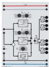
Appareil de commande universel pour la réalisation de hacheurs à commutation, d'alimentations à découpage et d'onduleurs autonomes monophasés.
