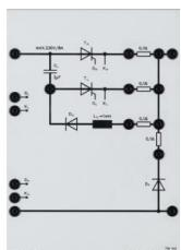
Thyristor avec circuit d'extinction par condensateur et avec bras de roue libre.
