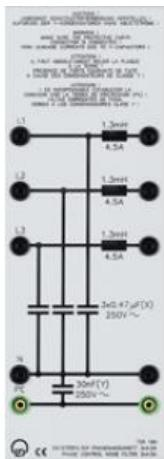
Filtre d'antiparasitage monoétagé, triphasé à forte atténuation en phase et symétrique, convient particulièrement bien pour les expériences en électronique de puissance sur les convertisseurs statiques à commutation par le réseau et à commutation forcée.
