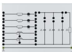
Charge resistive, inductive et capacitive pour tous les montages monophasés et triphasés de l'électronique de puissance.
