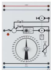
Potentiomètre à engrenage avec entraînement par moteur CC
