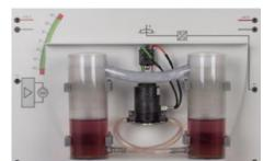
Système d'asservissement de l'inclinaison d'un navire
