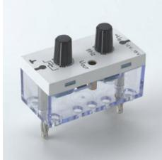
Élément enfichable STE 2/50 avec témoin du fonctionnement (LED) ainsi que 2 potentiomètres pour le réglage du rapport cyclique et de la fréquence pour la simulation du signal de vitesse de l'ABS ou de la durée d'injection T i pour les calculateurs d'automobile.
