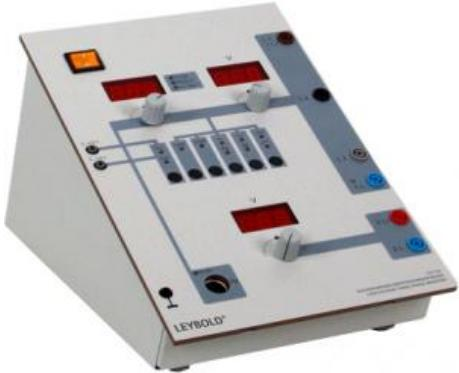
Le générateur triphasé est une unité d'alimentation de laboratoire disposée dans un boîtier de table pour générer des tensions continues, alternatives et triphasées pour l'alimentation des machines d'entraînement électriques (charges inductives- résistives) basées sur des onduleurs..
