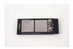
Le scanner de bande est un analyseur de spectre simplifié et est donc utilisé pour l'affichage spectral de signaux dans la gamme de fréquences.
