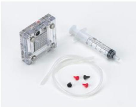
Elle combine les fonctions de l'électrolyseur et de la pile à combustible en un seul et même dispositif. Avec la membrane polymère échangeuse de protons (PEM = Proton Exchange Membrane) en guise d'électrolyte, aucun acide ni aucune base n'est nécessaire.
