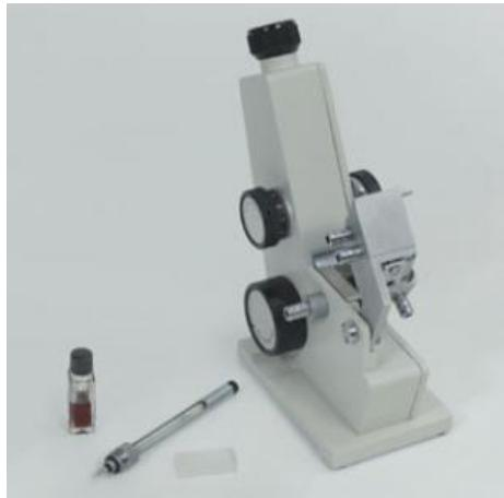
Permet la mesure des indices de réfraction d'échantillons liquides et solides pour une lumière de longueur d'onde  $\lambda = 589,3$  nm ainsi que la détermination de la dispersion moyenne, avec échelle de la teneur en sucre, dispositif d'éclairage, étalon avec indice de réfraction, flacon avec liquide de contact, thermomètre et clé d'ajustage.
