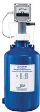
pour la production d'eau déminéralisée fourni avec cartouches rechargeables, 1,5 m de raccord et pièces de jonction R 3/4 et conductimètre électrique démontable 0-20 uS
