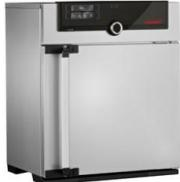
Modèle à convection naturelle tout en acier inoxydable (panneau arrière en tôle d'acier galvanisé) avec rainures périphériques embouties intégrant sur une grande surface les corps de chauffe sous manchon céramique.
