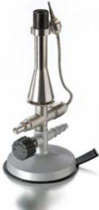
Modèle conforme à la norme DIN. Avec virole de réglage de l'admission d'air, pointeau de réglage de l'arrivée minimale et maximale du gaz et veilleuse. Le brûleur de sécurité coupe automatiquement l'arrivée du gaz si la flamme s'éteint involontairement. Pour remettre le brûleur en marche, il suffit d'appuyer sur le bouton rouge.
