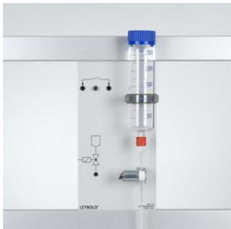
Pour le dosage de liquides par électrovanne actionnable manuellement ou par ordinateur. Avec 2 douilles pour le raccordement à la sortie de relais d'une interface d'ordinateur ; 1 touche pour le fonctionnement manuel, 1 LED pour le contrôle du fonctionnement. Sert par ex. à maintenir le pH constant dans le bioréacteur durant une fermentation.
