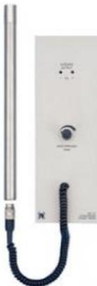
Pour la mesure de l'éthanol dans les milieux aqueux et gazeux, par ex. pour définir la concentration d'éthanol dans les liquides lors de fermentations. Le capteur à plaque filtrante en céramique est logé dans un boîtier en acier inoxydable ; la sensibilité peut être adaptée à la mesure considérée par un gain réglable. Une sortie analogique permet la connexion d'un enregistreur à compensation ou d'un ordinateur avec interface.
