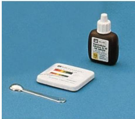
Plateau avec liquide indicateur et échelle de couleurs pour les expériences d'introduction des étudiants sur la détermination de la valeur du pH.
