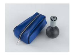
Pour la mesure rapide et exacte des concentrations de gaz et de vapeur dans l'air. Le détecteur de gaz se compose d'une poire et d'un support pour les tubes indicateurs. Ces tubes contiennent un système réactif provoquant un virage de la coloration en présence de la substance à mesurer. Fourni avec un mode d'emploi détaillé.
