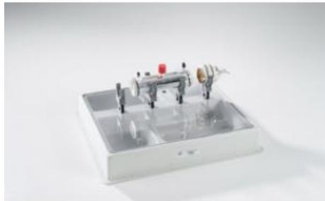
Pour la réalisation d'expériences avec le rayonnement infrarouge (rayonnement thermique), tout particulièrement sur l'absorption du rayonnement IR par le gaz carbonique et les autres gaz à titre de comparaison (effet de serre). Le kit se compose d'un émetteur IR, d'une cuve de mesure réfléchissante et d'un support pour la pile thermoélectrique de Moll.
