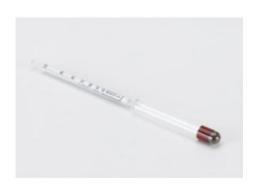
Pour déterminer la masse et le volume en %, sans thermomètre.
