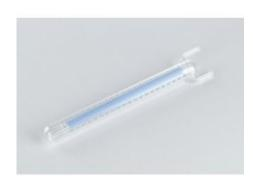
Manomètre à tube plongeur d'après Schiele, gradué. Recommandé comme instrument de contrôle de la pression pour les expériences avec les seringues à gaz.
