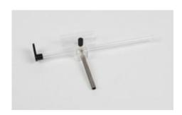
Pour seringue à gaz 100 ml. En plastique parfaitement transparent qui permet une lecture complète de l'échelle graduée de la seringue. La butée arrête le piston avant qu'il ne sorte de la seringue.
