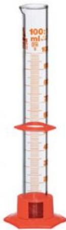
Selon DIN en verre borosilicaté 3.3, avec pied en plastique incassable, interchangeable et bague de sécurité pour éviter tout endommagement si l'éprouvette venait à se renverser.
