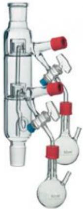
**Colonne pour distillation fractionnée, 2 plateaux, 280 mm, 2 RN 29/32, 2 GL 18**
