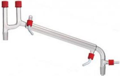
En verre borosilicaté 3.3, avec olives pour le branchement de l'eau de refroidissement et un raccord fileté GL 18 pour le thermomètre.
