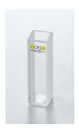
Cuvette rectangulaire, 10 mm, VIS, verre optique
