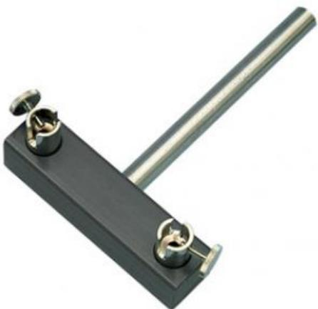
Pour deux électrodes (électrodes droites jusqu'à max. 8 mm de diamètre ou électrodes en plaque jusqu'à maximum 3 mm d'épaisseur). Avec des douilles de raccordement de 4 mm pour le câble d'expérimentation et une tige (10 mm Ø) pour la fixation au support.
