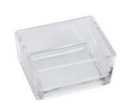
Pour les expériences d'électrochimie ; à utiliser avec les électrodes en plaque (59153 à 61).
