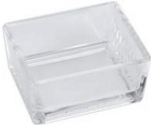
Pour les expériences d'électrochimie ; à utiliser avec les électrodes en plaque ( 59153 à 61).
