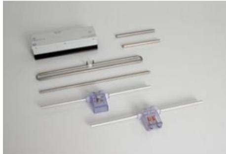
Avec une fréquence de service de 433,92 MHz (bande UHF des 70 cm/ bande ISM (Industrial, Scientific, Medical) pour l'étude expérimentale des conditions de propagation d'ondes électromagnétiques (radiodiffusion) dans l'espace libre et dans des milieux diélectriques, par ex. dans l'eau et sur des systèmes à fils de Lecher.
