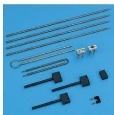
A utiliser avec l'émetteur d'ondes décimétriques (557 551), pour l'étude et la démonstration de la propagation des ondes électromagnétiques le long de fils ;
