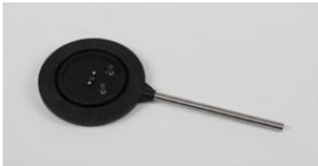
Capsule à électret, pour étudier le son à l'appui d'expériences simples, dans monture, avec douilles de raccordement, sur tige.
